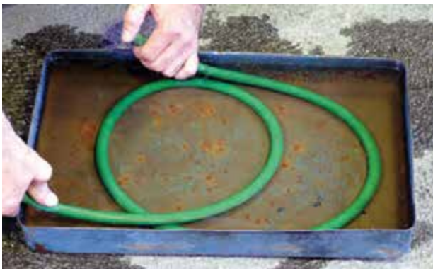
شکل ۲-۹۹ – کنترل نشتی شیلنگ در آب
