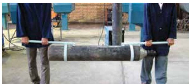
شکل ۸۶-۲ روش درست جابه‌جا کردن کپسول
