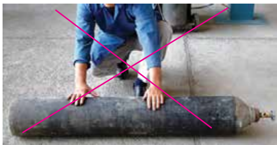
شکل ۲-۸۴ – کار اشتباه در حمل کپسول
