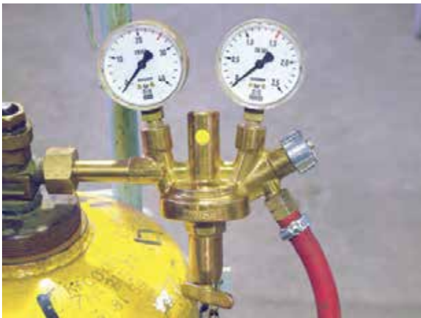
شکل ۱۳۵-۲ پیچ تنظیم فشار استیلن روی رگولاتور
