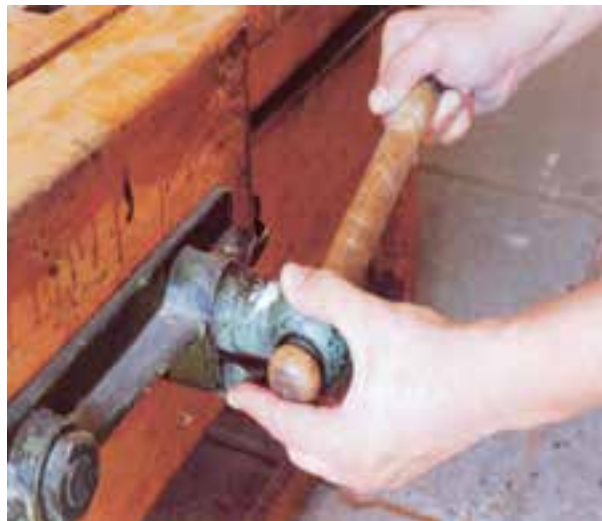
شکل ۲-۱۸- ضامن باز و بسته کردن آزاد گیره.
