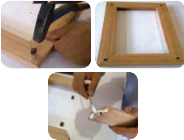
شکل ۲-۳۳ مراحل متصل نمودن قطعات قاب
