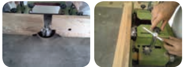
شکل ۲-۳۱ الف تنظیم اره فارسی بر
