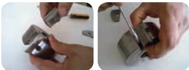
شکل ۲-۲۷ تنظیم و محکم کردن تیغه داخل توپی
