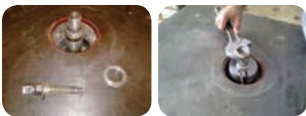
شکل ۲-۲۸ تنظیم کردن توپی در دستگاه فرز
