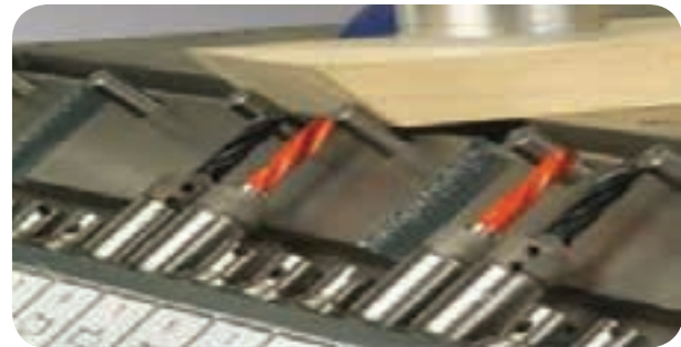
شکل ۳-۵ سوراخ کاری قطعات زاویه‌دار
