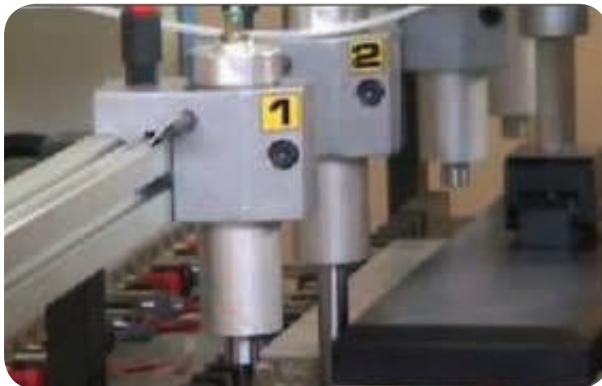
شکل ۳-۷ قطعه کار، توسط جک‌ها گونیا شده است.
