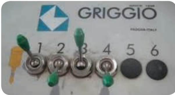
شکل ۳-۶ کلیدهای بالا و پایین بُرندهٔ جک‌ها
