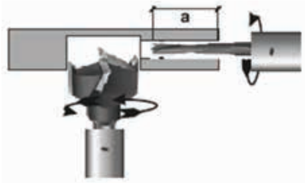
شکل ۳-۱۴ ابتدا متنه افقی سوراخ کاری را انجام می دهد و سپس متنه عمودی
