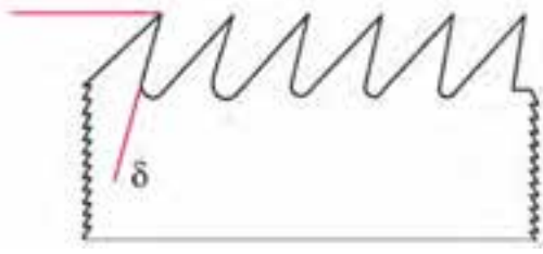
شکل ۵-۳۴- زاویه‌ی برش، کمتر از ۹۰ درجه.
