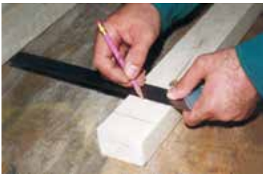
شکل ۵-۴۸- فم‌کشی قطعه کار به‌وسیله‌ی گونیا و مداد.
