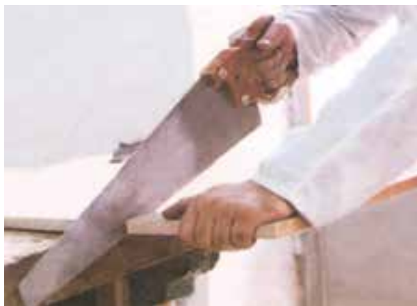
شکل ۵-۸- نمونهی برش به وسیله اژه دم روباهی.
