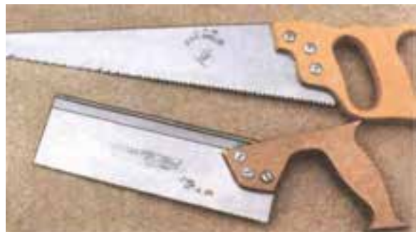
شکل ۵-۲- اژه‌های دندانه‌رو به جلو.
