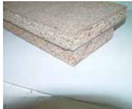
شکل ۳-۱۴۵- تخته فرده چوب با لایه‌های تدریجی.
