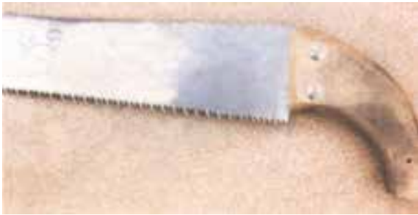
شکل ۵-۳- اژه‌ی دندانه‌رو به عقب.
