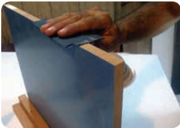
شکل ۴-۴۶ سنباده زدن نر کار
