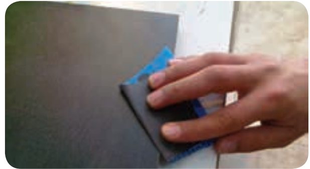
شکل ۴-۳۰ پرداخت لبه لبه‌های نوار شده با سنباده
