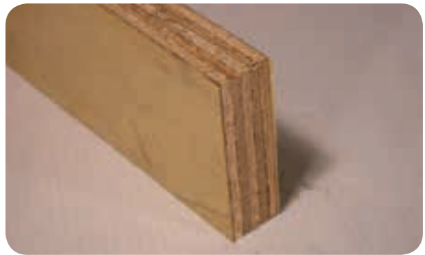
شکل ۴-۱ تخته‌های چند لایه به صورت لایه لایه بوده و به طور کلی، ناصاف است.
