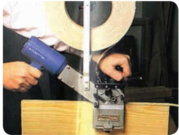
شکل ۴-۱۹ نحوه نوار کردن با سشوار
