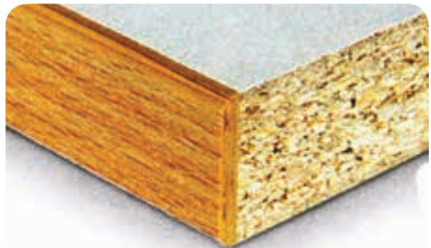
شکل ۴-۲ نئوپان‌ها، دارای لبه‌هایی فاقد زیبایی و صافی هستند.
