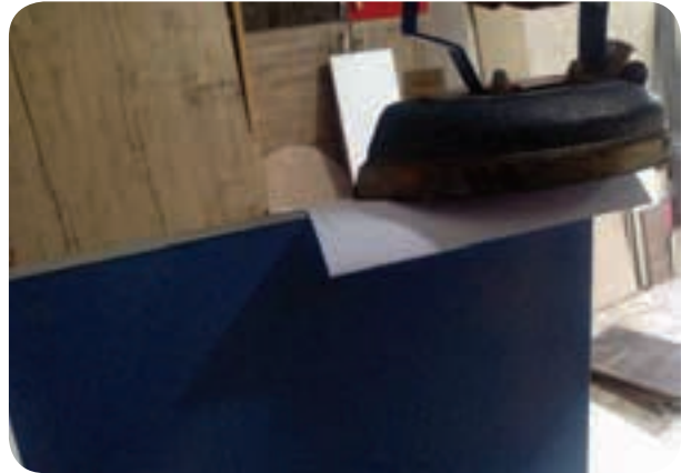
شکل ۴-۴۸ حرکت اتو در روی قطعه کار
