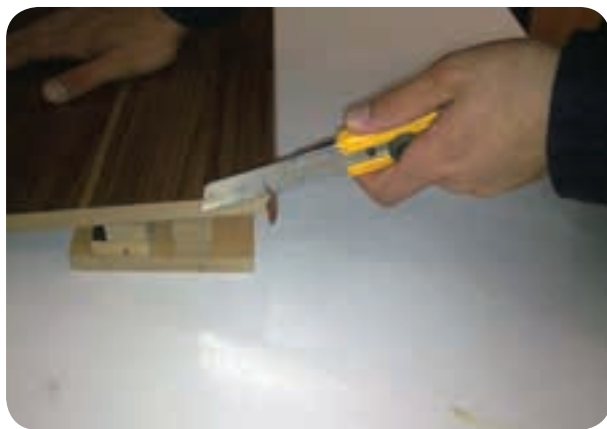
شکل ۲۸-۴ قطع کردن سر و ته نوار با کاتر
