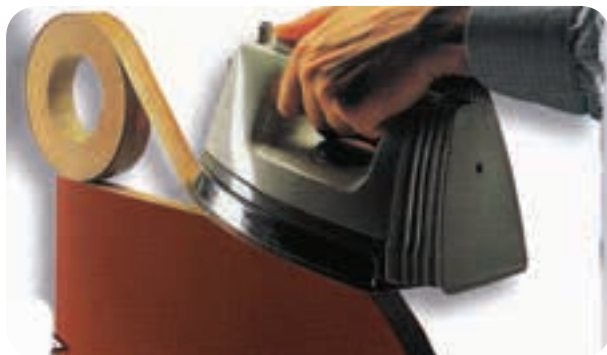
شکل ۴-۱۶ نوار کردن لبه‌های قوس‌دار توسط اتو
