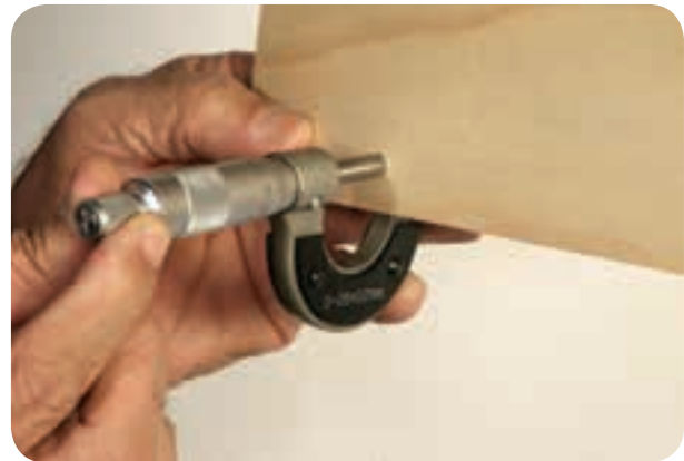
شکل ۸۶-۵ اندازه‌گیری ضخامت روکش با میکرومتر
