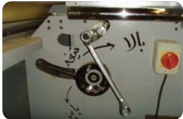
شکل ۵-۶۳ پیچ‌های تنظیم زاویه خطزن و تیغه اصلی
