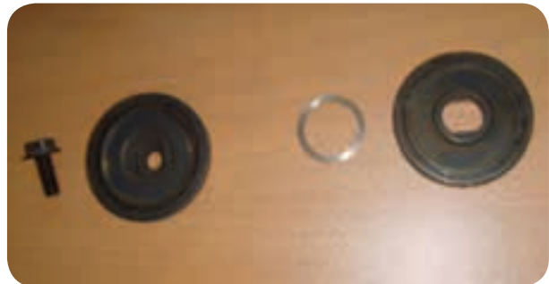
شکل ۵-۶۴ واشر واسطه سوراخ وسط تیغه اره و کفشک‌ها
