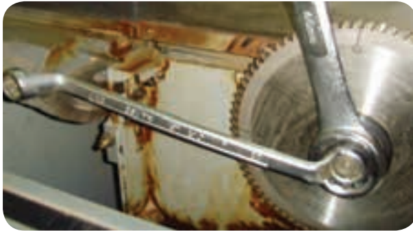
شکل ۵-۶۵ نحوه باز و بسته کردن تیغه اره
