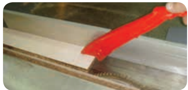
شکل ۳۲-۵ هل دادن قطعه باریک در برش به وسیله شابلون ساده
