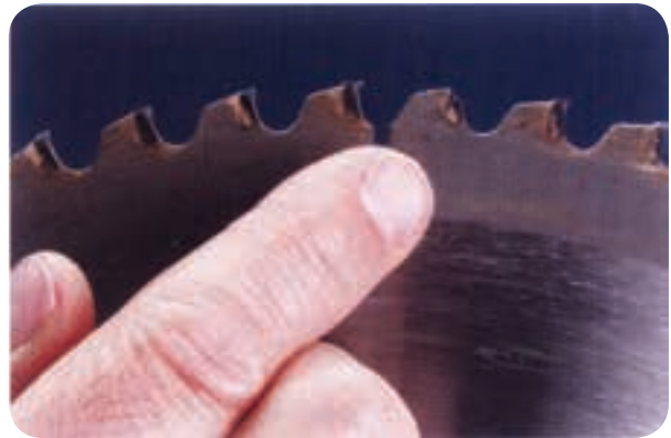
شکل ۵-۴۹ دندانهای اره شکسته یا کند شده
