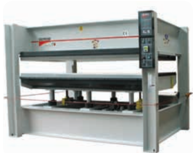
شکل ۱۱۱-۵ بندهای قطع اضطراری برق پرس در اطراف آن
