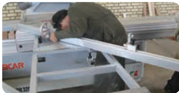
شکل ۵-۵۸ تنظیم دو کفشک کنترل اندازه‌گیری
