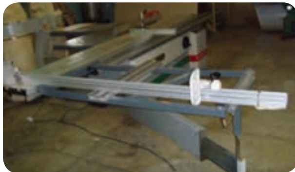
شکل ۵-۵۷ میله کشویی جلوی میز متحرک برای برش صفحات بزرگ
