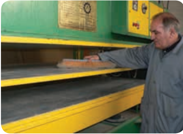
شکل ۱۱۲-۵ تمیز کردن پرس در پایان کار
