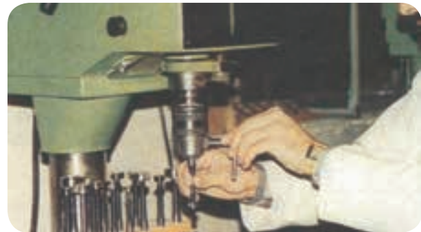
شکل ۳۶-۵ آچار سه نظام و گیره نگهداشتن قطعات کوچک در ماشین مته عمودی
