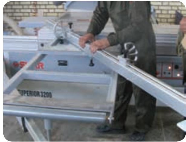
شکل ۵-۵۹ تنظیم گونیا یا تکیه‌گاه برای برش کج صفحات
