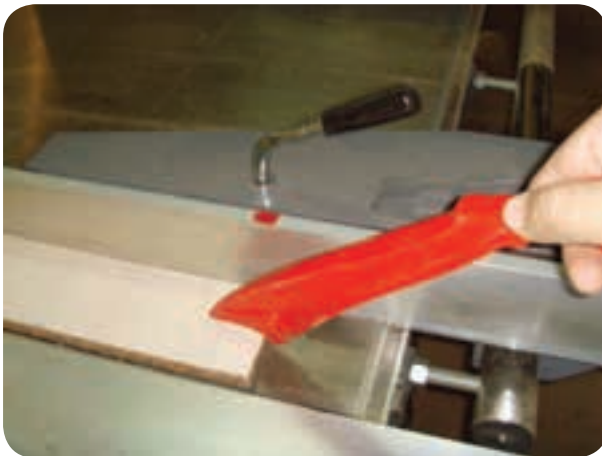
شکل ۷۴-۵ استفاده از وسیله کمکی هل دادن قطعه باریک
