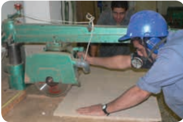
شکل ۸۱-۵ استفاده از وسائل حفاظتی در برش
