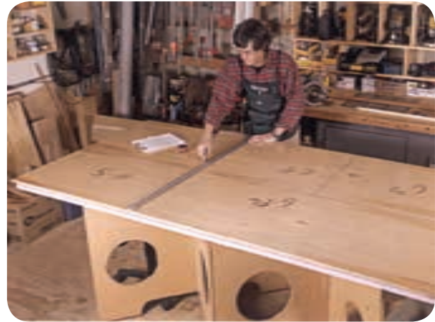
شکل ۵-۵۵ خط کشی صفحه ام‌دی‌اف برای برش
