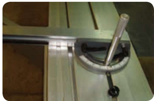
شکل ۵-۶۰ گونیای کوچک قابل تنظیم برای برشکاری
