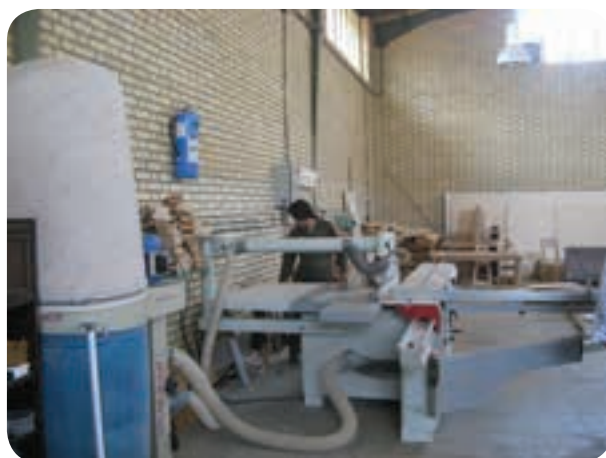
شکل ۶۸-۵ مکنده مناسب ماشین دور کن
