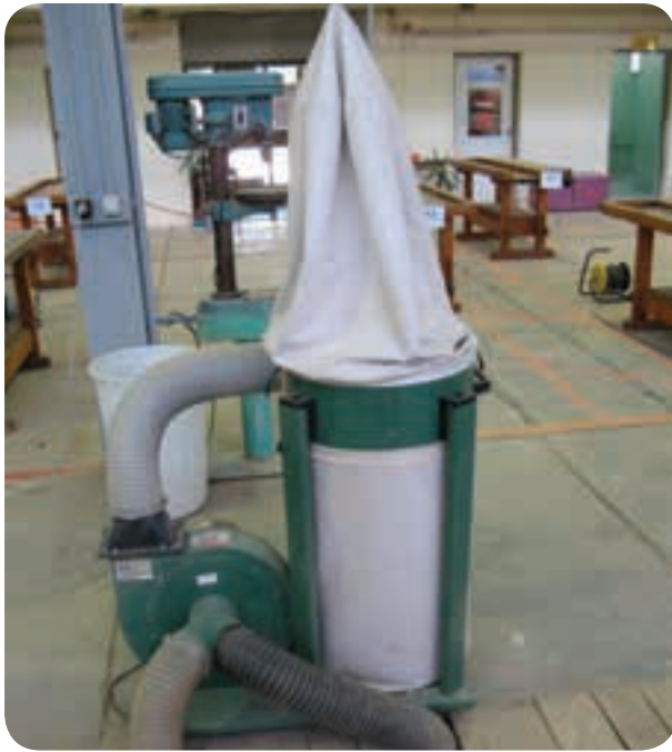
شکل ۲۹-۵ خروج ضایعات از طریق کانال پوشیده شده
