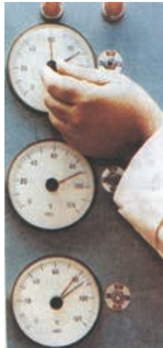
شکل ۹۴-۵ سه گیج تنظیم حرارت برای سه طبقه پرس
