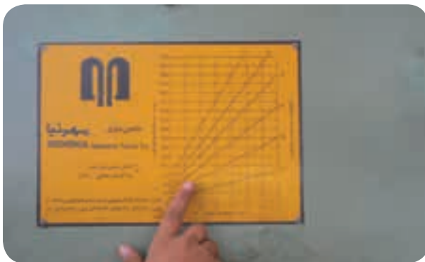
شکل ۹۶-۵ منحنی تنظیم فشار در یک پرس برقی ساخت ایران
