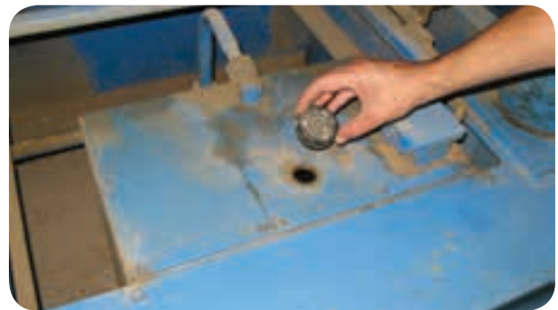
شکل ۵-۱۰۲ کنترل و تعویض روغن هیدرولیک مخزن
