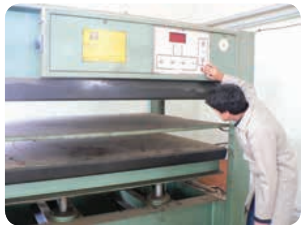
شکل ۵-۹۹ کنترل کار کردن صحیح پرس
