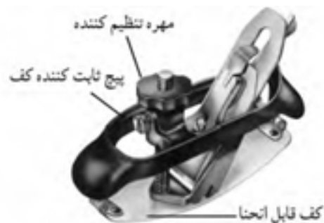
شکل ۶-۴۶- قسمت‌های مختلف رنده کاس و سینه.
