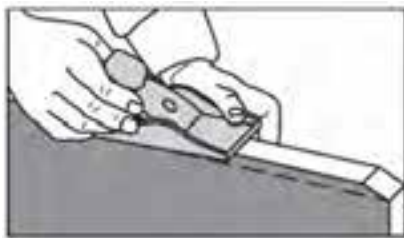
شکل ۶-۸۸- ایجاد پخ، هنگام رندیدن کلهی چوب.
