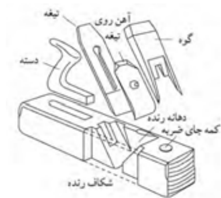
شکل ۱۳-۶. قسمت‌های مختلف اجزای رنده پوچی و نحوه‌ی جاگذاری آنها.
