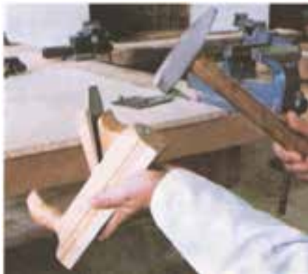
شکل ۱۵-۶. رعایت اصول ایمنی، هنگام فارغ کردن تیغه رنده.
