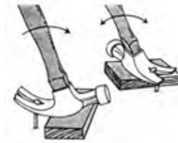
شکل ۷-۳۸- استفاده از چکش میخ کش برای بیرون کشیدن میخ.
