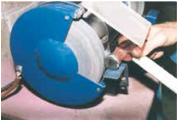
شکل ۷-۴۰- گرفتن پلیسه به وسیله‌ی سنگ سنباده.
