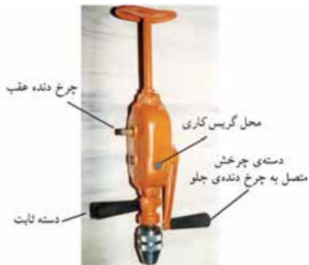
شکل ۱۲-۴- قرار گرفتن دسته دریل در پایین (قدرت زیاد).
