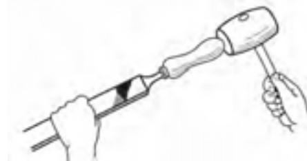
شکل ۱۱-۲۰- شکل جا زدن دسته‌ی چوب‌سا و سوهان.
