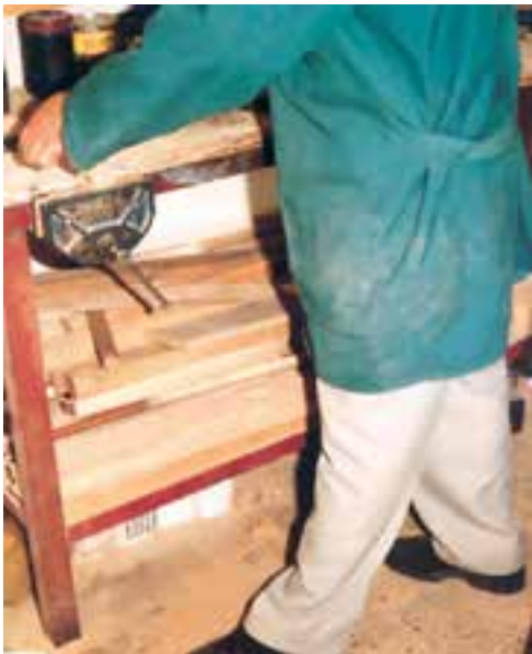
شکل ۱۱-۲۷- طرز صحیح ایستادن هنگام استفاده از چوب‌سا و سوهان.
