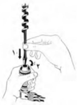
شکل ۱۲-۳۵- بستن سر مته به دریل.
