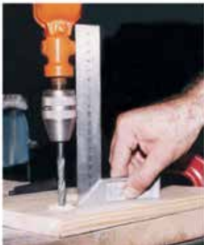
شکل ۱۲-۴۷- آزمایش گونیايي قرار گرفتن دریل.
