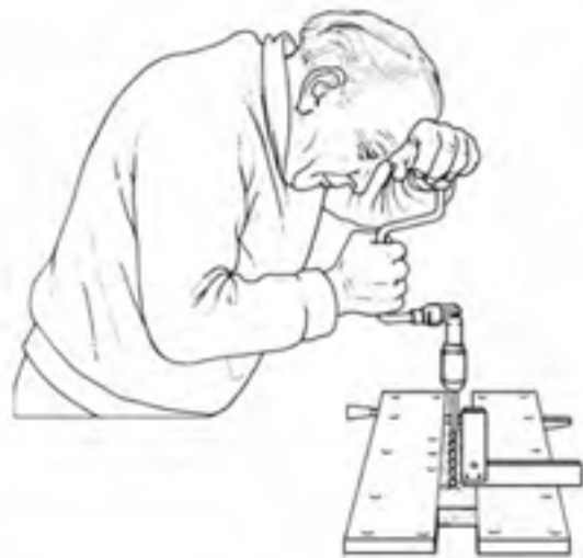
شکل ۱۲-۴۲- قرار دادن نوک دریل روی قطعه کار و کنترل آن با
