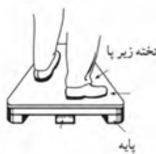
شکل ۱۱-۲۸- استفاده از زیرپایی، هنگام سوهان‌کاری یا چوب‌سا زدن.
