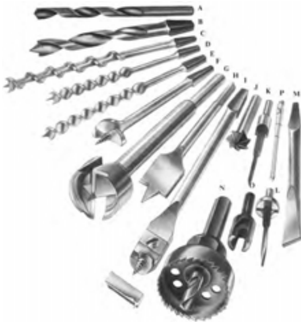
شکل ۱۱-۱۲- انواعی از سر مته‌های مخصوص چوب.
