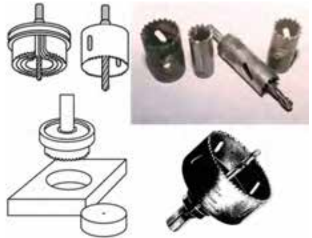
شکل ۱۲-۲۸- سر مته‌ی گردبر و کاربرد آن.
