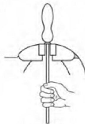
شکل ۱۱-۲۱- روش درآوردن سوهان از دسته.
