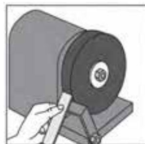
شکل ۱۴-۴۴- تنظیم تکیه‌گاه سنگ سنباده.
