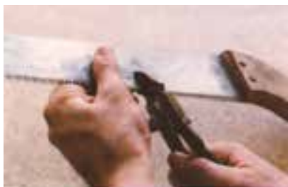
شکل ۱۴-۵۴- فم کردن بقیه دندانها به طرف پایین.
