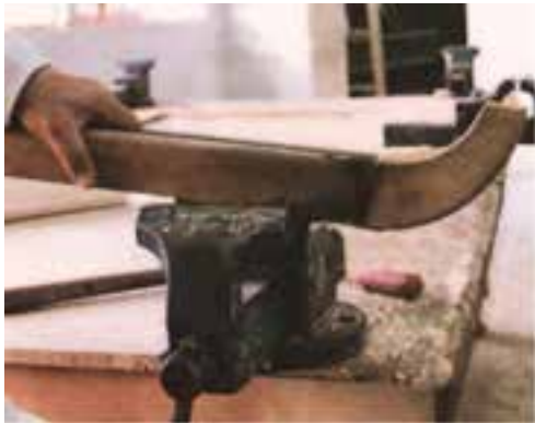
شکل ۱۴-۵۱- استفاده از دو قطعه چوب به جای تنگ.
