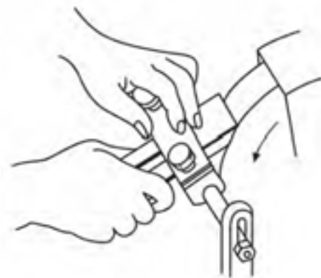
شکل ۱۴-۲۴- تیزکردن تیغه رنده با سنگ سنباده.
