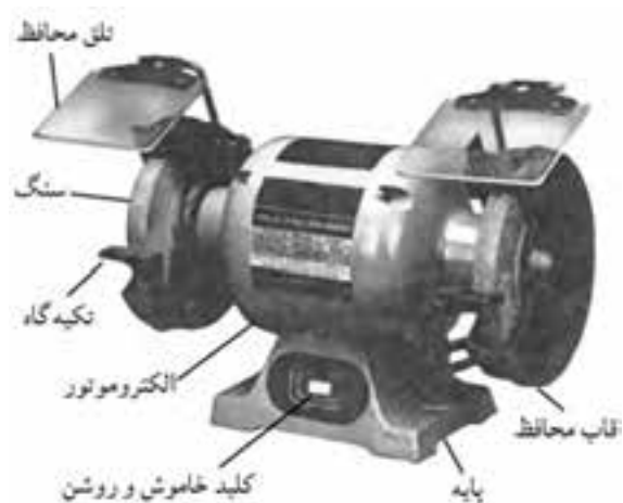
شکل ۱۲-۱۴. قسمت‌های مختلف سنگ سنباده.
