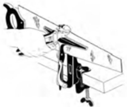
شکل ۱۴-۵۶- انجام عمل چپ و راست کردن به وسیله انبر چپ و راست کن.
