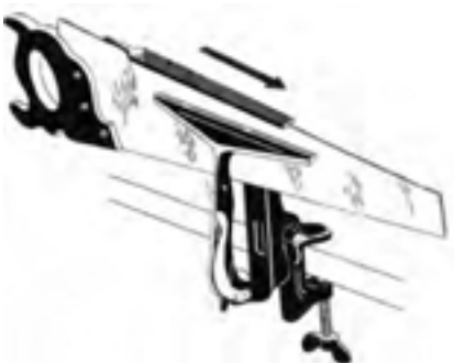
شکل ۱۴-۶۲- میزان کردن دندان‌های اره به وسیله سوهان.
