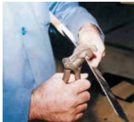
شکل ۱۴-۵۳- چپ و راست کردن دندان بدون استفاده از تنگ.
