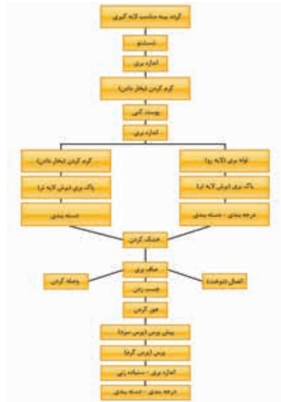
شکل ۴-۲- شمای فرآیند تولید سافت تمته پندلایه.
