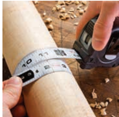
شکل ۶-۸- اندازه گیری محیط استوانه با متر پلاستیکی.
