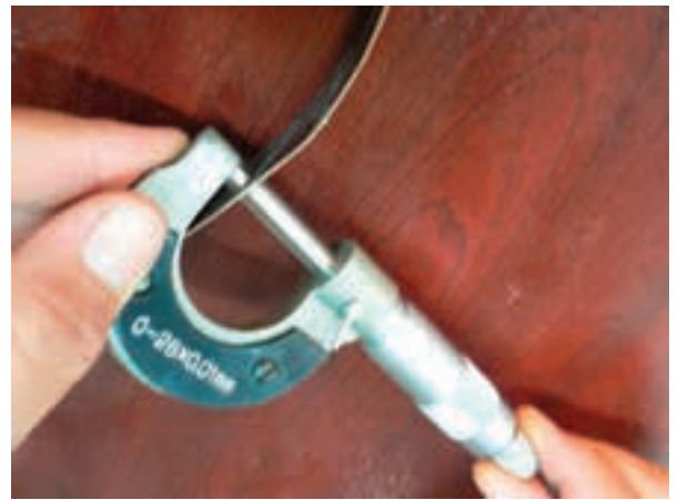
شکل ۳-۸. میکرومتر با میدان اندازه‌گیری (۰ - ۲۵) میلی‌متر.
