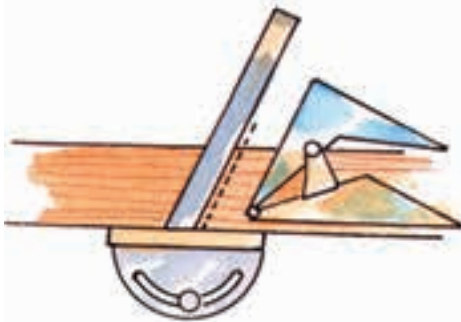
شکل ۵-۸. اندازه‌گیری و انتقال زاویه با استفاده از گونیا (بازشو و نقاله).
