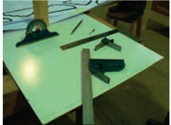
شکل ۱۰-۸- گونیاى مرکب و اجزاء آن.
