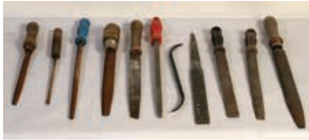
شکل ۱۵-۹- اکسیده شدن سوهان و چوبساک به علت (رطوبت).
