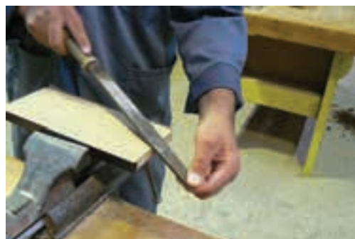
شکل ۱۸-۹- از بین بردن لبه اضافی نوار چسببندده شده.
