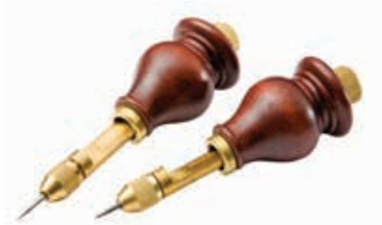
شکل ۷-۱۴- درفش که به عنوان سوزن خط‌کشی نیز کاربرد دارد.
