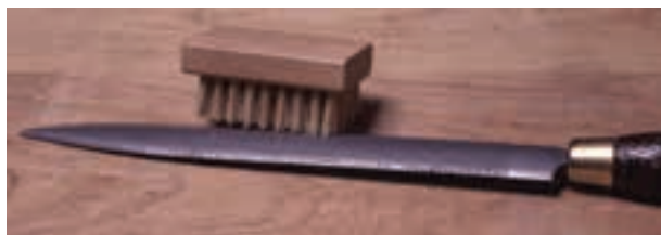
شکل ۱۹-۹- پاک کردن سوهان و چوبسآء با برس.
