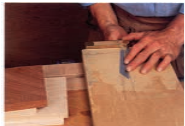
شکل ۲۱-۷- ترسیم خطوط زاویه‌دار با گونیا باز شو.
