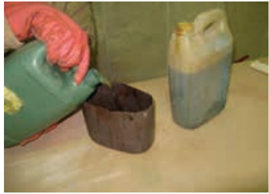
شکل ۸-۱۰- رقیق کردن روغن الیف با تینر روغنی.
