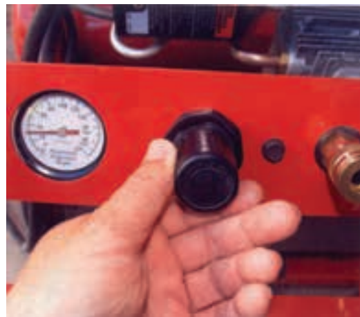
شکل ۵-۷- دستگاه تنظیم کننده فشار.
