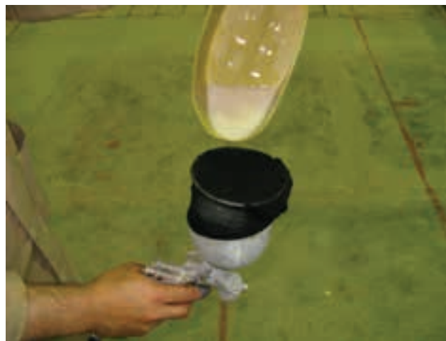
شکل ۳۹-۸- استفاده از جوراب نازک به عنوان صافی.
