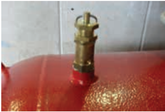
شکل ۱۰-۷- سوپاپ کمپرسور برای فروغ هوای اضافی.
