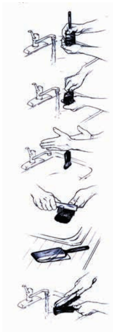
شکل ۱۴-۸- روش شستن و خشک کردن قلم موها.
