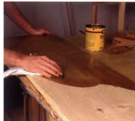
شکل ۱-۱۰- روغن اندود کردن سطح کار.
