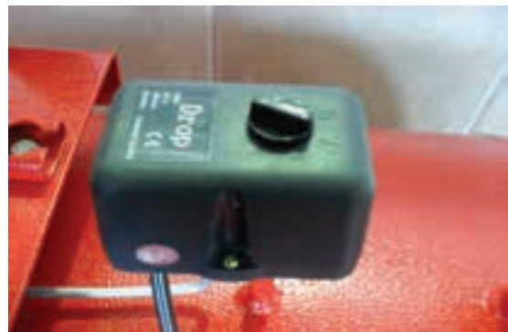
شکل ۹-۷- جعبه کلید قطع و وصل جریان برق.
