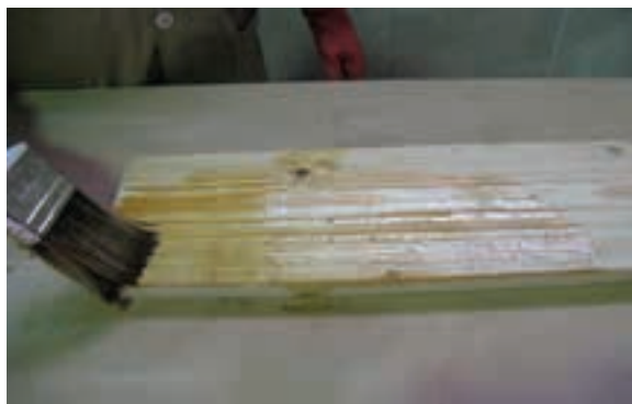
شکل ۷-۱۰- روغن اندود کردن سطح چوب نراد با روغن الیف.
