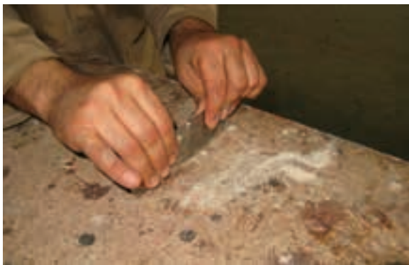
شکل ۱۱-۱۰- برداشتن چسب، رنگ و مواد اضافی از روی میز کار به کمک لیسه پرداخت.
