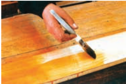
شکل ۳۴-۸- سیلرکاری در جهت الیاف.
