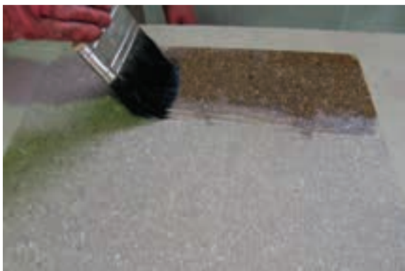
شکل ۴-۱۰- روغن اندود کردن سطح یک نئوپان با روغن بزرک.
