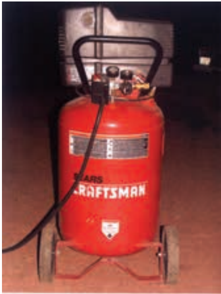
شکل ۷-۳- کمپرسور با مخزن عمودی.
