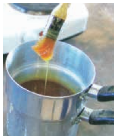
شکل ۷۱-۱۲- ظرف مخصوص برای ذوب کردن لاک که دو طبقه بوده و در اثر حرارت بخار آب لاک ذوب می‌شود.
