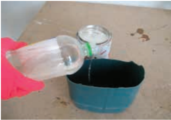
شکل ۲۸-۱۲- استفاده از تینر فوری در روغن جلا برای سریع خشک شدن رنگ.
