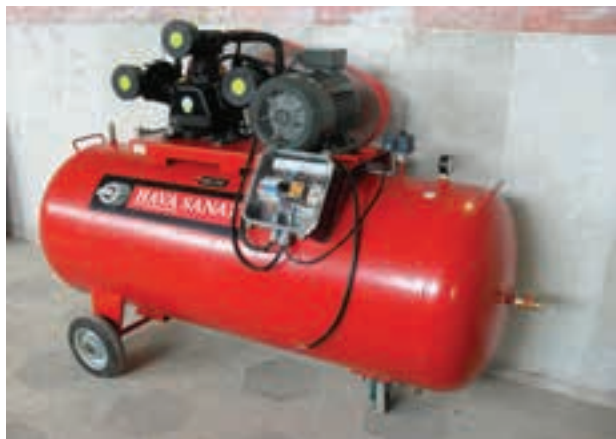
شکل ۴۴-۱۳- یک کمپرسور با سه سیلندر و حجم ۷۵۰ لیتر.
