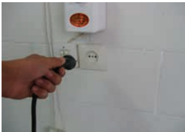
شکل ۲۵-۱۳- قطع کردن برق دستگاه سنباده لرزان.
