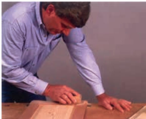
شکل ۱۲-۳۸- زدن آستری گردویی به سطح کار.
