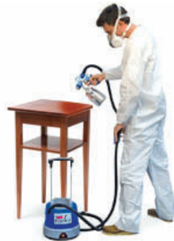
شکل ۱-۱۴. هنگام استفاده از پیستوله از ماسک ایمنی استفاده کنید.
