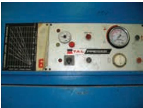
شکل ۱۵-۲۶- تابلوی تنظیمات حرارت - فشار و زمان در پرس هیدرولیک.
