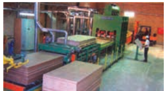
شکل ۴-۱۵ (روکش کاری) M.D.F با پرس.
