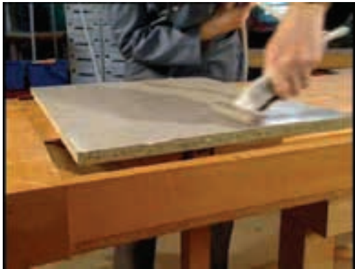
شکل ۸۷-۱۵- چسب‌زنی عرضی سطح صفحه با تیغه مخصوص.
