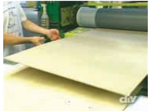
شکل ۱۱-۱۵- چسب زدن صفحه با ماشین چسب‌زن غلطکی.
