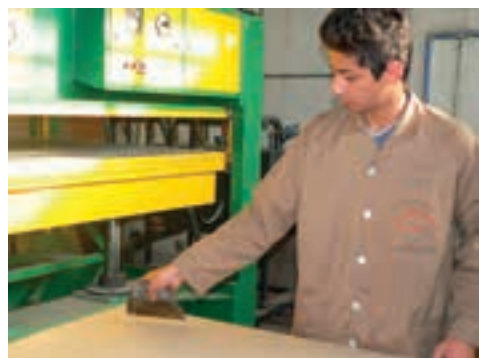
شکل ۷۹-۱۵. کاردک شانه‌ای را ۴۵ درجه در دست بگیرید.
