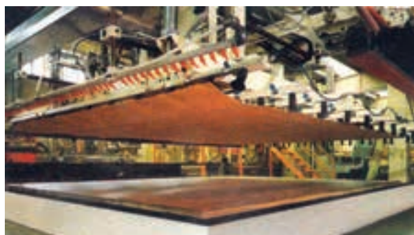
شکل ۱۰۹-۱۵- استقرار ورق ملایمه روی صفحات.
