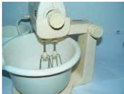
شکل ۵۳-۱۵- استقرار موتور روی دستگاه همزن.
