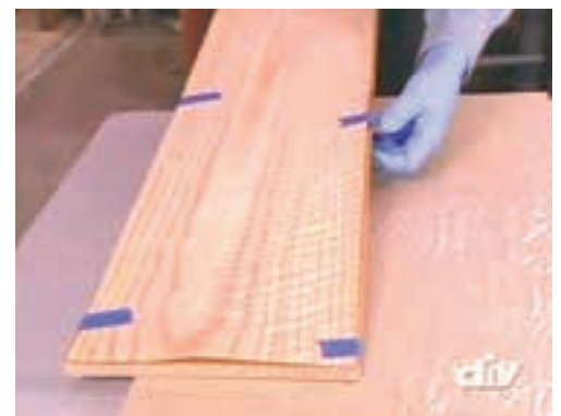
شکل ۱۲-۱۵- ثابت کردن روکش چسب زده شده روی صفحه با نوار چسب.
