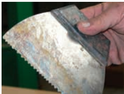
شکل ۷۸-۱۵. استفاده از کاردک شانه‌ای.
