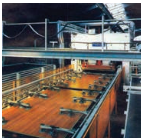
شکل ۱۰۸-۱۵- پرس ملایمه روی M.D.F و H.D.F و نئوپان.
