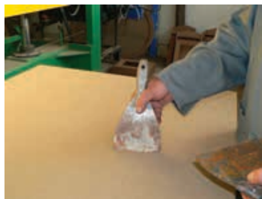
شکل ۷۷-۱۵. کاردک ساده در پخش کردن چسب.
