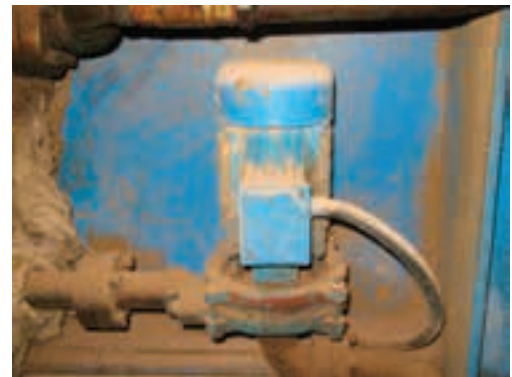
شکل ۱۷-۱۵- الکتروپمپ پرس هیدرولیک یک طبقه.
