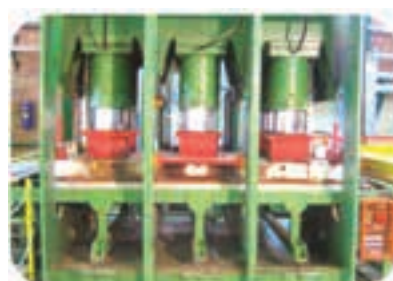
شکل ۱۰۵-۱۵- پرس هیدرولیکی گرم ۱۰۴۲ تنی.
