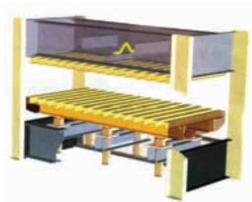
شکل ۱۶-۱۵- اسکلت و چهارچوب پرس هیدرولیک یک طبقه.
