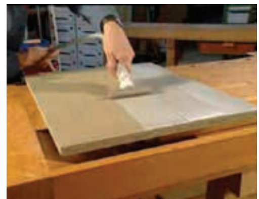
شکل ۸۶-۱۵- چسب‌زدن طولی صفحه با تیغه مخصوص.
