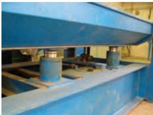
شکل ۳۲-۱۵- سیلندر و پیستون جک‌های پرس هیدرولیک.
