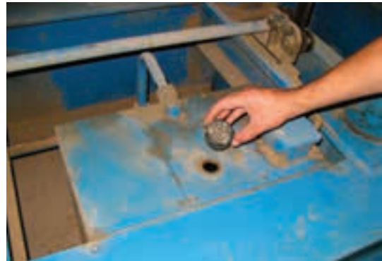
شکل ۲۰-۱۵- باز کردن دریاچه کارتر روغن.
