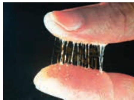
شکل ۶۷-۱۵. اندازه‌گیری غلظت چسب با انگشت.
