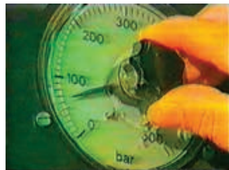
شکل ۱۵-۲۵- گیج تنظیم فشار پرس هیدرولیک گرم.
