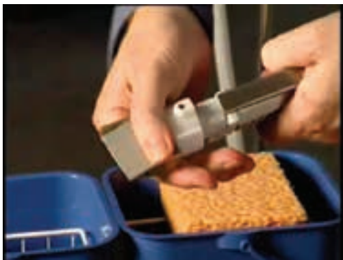
شکل ۸۸-۱۵- شستشوی تیغه چسب‌زن دستی پنوماتیک.
