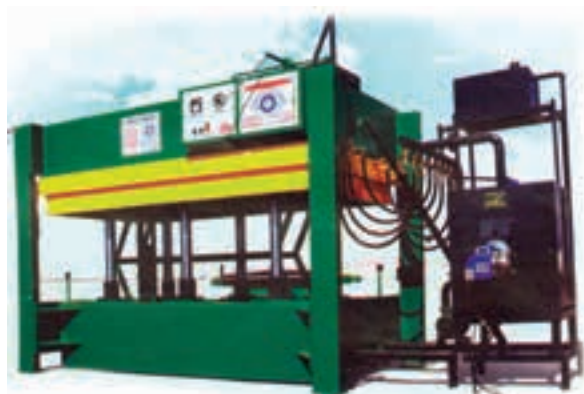
شکل ۴۲-۱۵. پرس هیدرولیک با سیستم استفاده از روغن داغ در صفحات.
