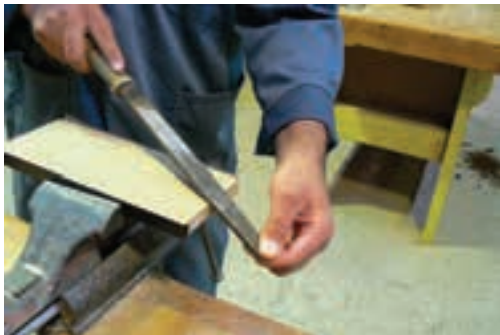
شکل ۱۹۹-۱۵- قطع کردن روکش اضافی با سوهان.
