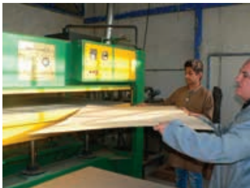
شکل ۱۸۶-۱۵- خارج کردن صفحات پرسکاری شده.
