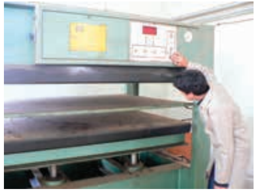
شکل ۱۵۸-۱۵- کنترل بین صفحات پرس بعد از باز کردن آن.
