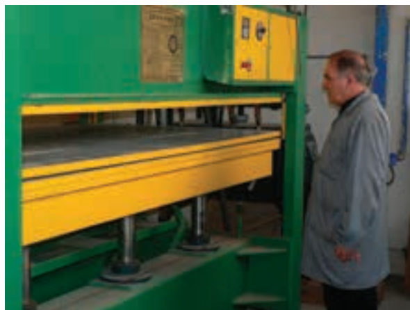
شکل ۱۸۴-۱۵- صفمه پرس تا روی تپه‌ی لاستیکی پایین می‌آید.
