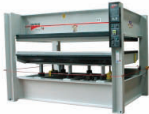
شکل ۲۰۶-۱۵- سیم قطع برق اضطراری پرس.
