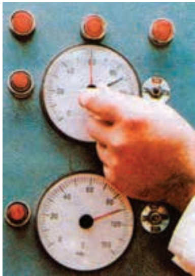
شکل ۱۷۵-۱۵- تنظیم گیج‌های حرارت پرس برقی.
