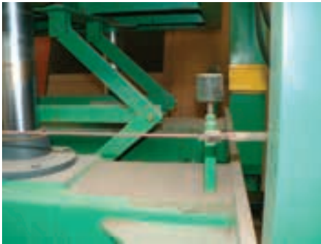
شکل ۱۴۵-۱۵. اهرم‌ها با توپی لاستیکی مقر صفحه پرس.
