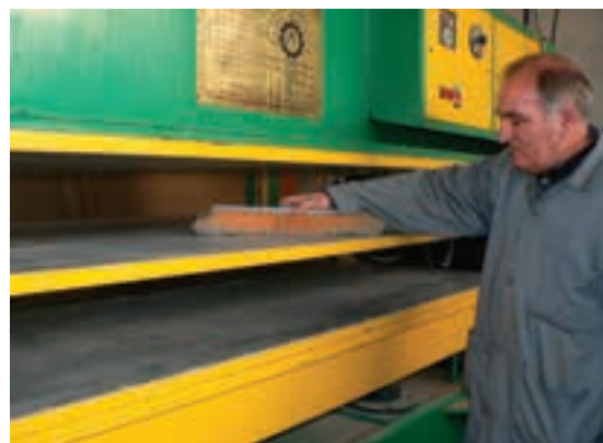
شکل ۱۷۰-۱۵ تمیز کردن صفحه قبل از پرسکاری.
