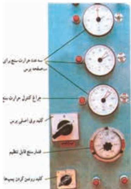
شکل ۱۳۲-۱۵. اجزای تنظیم حرارت و فشار پرس.
