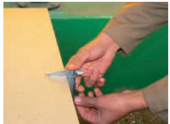
شکل ۱۵۵-۱۵. کنترل ضخامت با کولیس قبل از پرسکاری.
