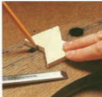
شکل ۱۷-۱۷- فماتکشی ممل گره با شابلون.
