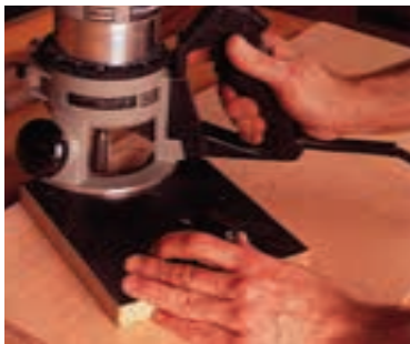
شکل ۲۱-۱۷- استفاده از فرز دستی.
