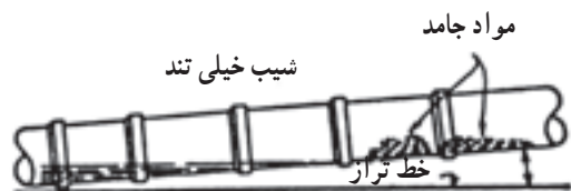
شکل ۱۱-۳ الف - نتیجه‌ی شیب زیاد لوله‌ی افقی فاضلاب
