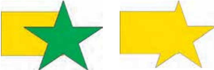
شکل ۴۵-۵ قبل و بعد از روش اجرای فرمان Weld
