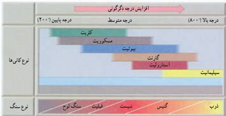
شکل ۸-۸ - تغییراتی که کانی‌های موجود در شیل در درجات مختلف دگرگونی به خود می‌بینند.
