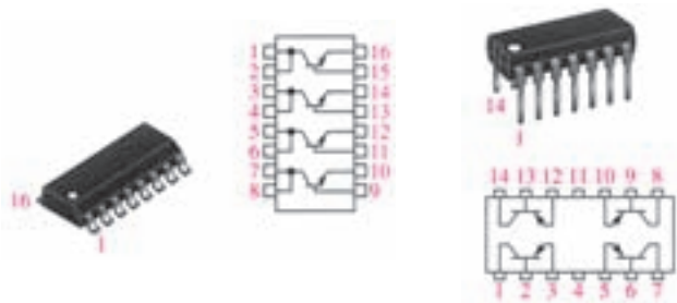
(د) چهار ترانزیستور در یک بسته بندی به صورت DIPIC (ج) چهار ترانزیستور در بسته بندی نصب سطحی
