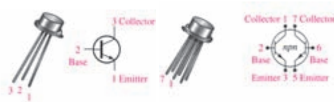
(ب) ترانزیستور در بسته دوتایی (ت) ترانزیستور با بسته بندی ۱۸ TO
