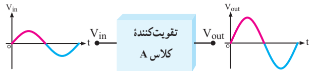
شکل ۵-۱- موج ورودی و خروجی تقویت کننده کلاس A
