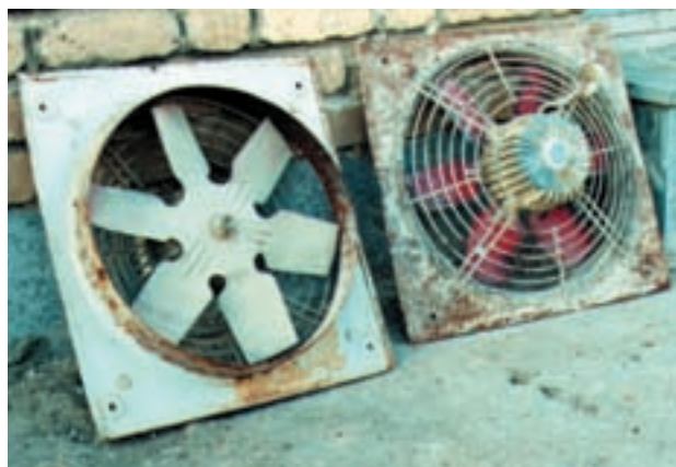
تعویض هواکشهای خراب و فرسوده
