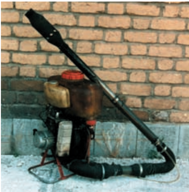
شعله افکن جهت حرارت دادن
