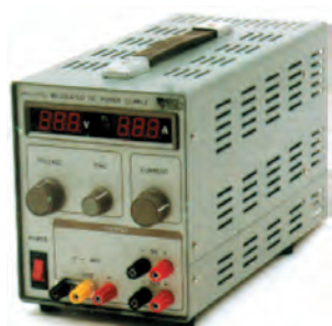
منبع تغذیه‌ی الکترونیکی با نشان‌دهنده‌ی هفت‌قطعه‌ای
