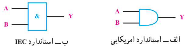
شکل ۱۱-۲ - علائم اختصاری دروازه‌ی AND
