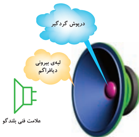
شکل ۱-۶۶ یک نمونه بلندگو، همراه با برش و علامت فنی آن
