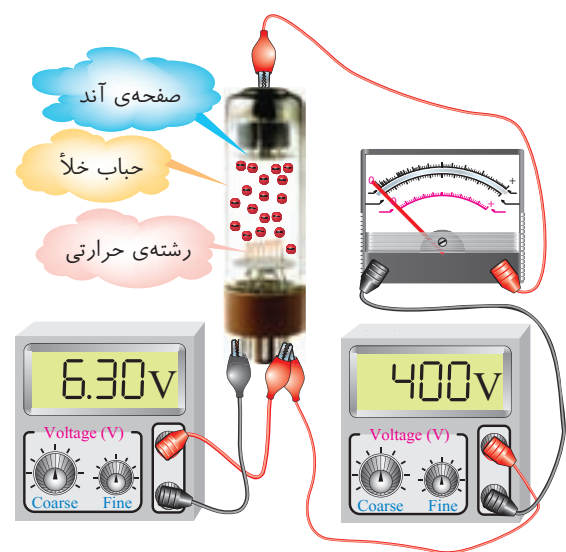
شکل ۲-۶ تعویض قطبین باتری منفی به آند و مثبت به کاتد
