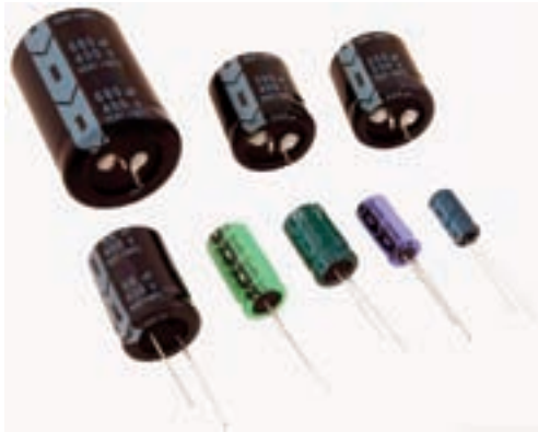
شکل ۱-۵۲ شکل ظاهری خازن الکترولیتی و علامت اختصاری آن
