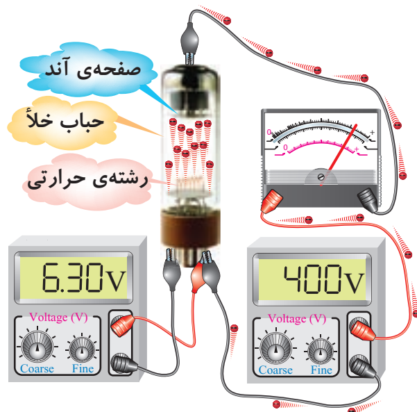
شکل ۲-۵ عبور جریان از حباب خلأ
