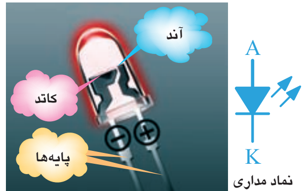
شکل ۳-۵۵ نماد مداری و ساختمان داخلی LED
