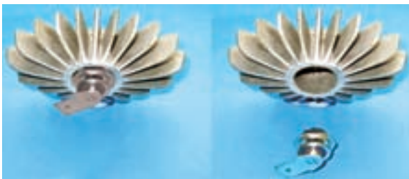
شکل ۳-۲۷ دو نمونه دیود نصب شده روی گرماگیر
