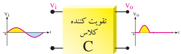
شکل ۵-۸۳ در تقویت کننده‌ی کلاس C قسمت کمی از نیم سیکل مثبت یا منفی تقویت می‌شود
