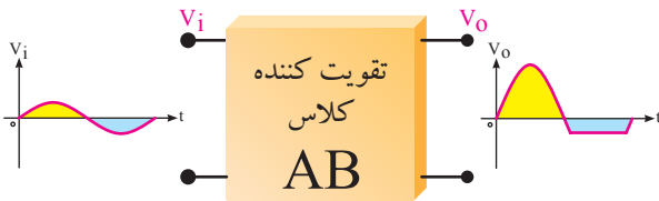
شکل ۵-۸۱ تقویت کننده‌ی کلاس AB، سیگنال را از ۱۸۰ درجه بیش‌تر و از ۳۶۰ درجه کم‌تر تقویت می‌کند.
