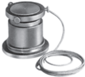
وسیله‌ای برای تعیین میزان ناخالصی در مصالح ریزدانه
