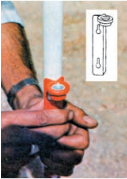
شکل ۱۰-۲- تراز نبشی و طرز استفاده از آن
