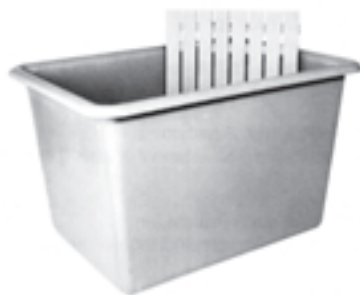
حوضچه نگهداری برای نمونه‌های آزمایشی
