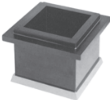
قالب نمونه‌های مکعبی بر اساس استاندارد BS
