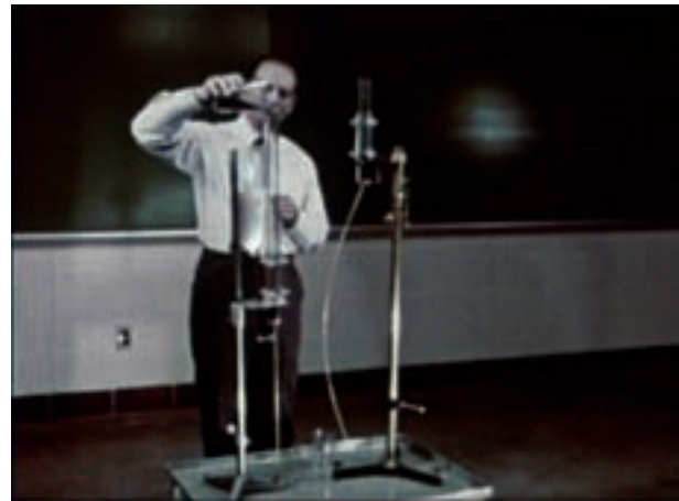
الف- مدل دو ستون با ارتفاع مختلف که توسط ماسه بارگذاری می‌شود
