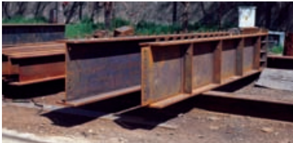
شکل ۵-۱۵- شاهتیرهای ساخته شده از تیر ورق
