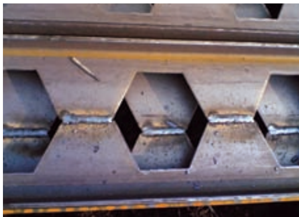
جوشکاری کامل دوطرف تیر لانه‌زنبوری
