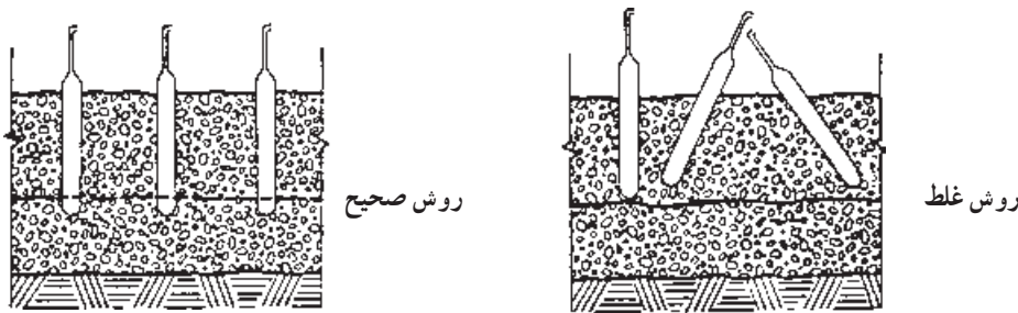
شکل ۶-۱۰- روش قرار دادن لرزاننده‌های درونی در داخل بتن
