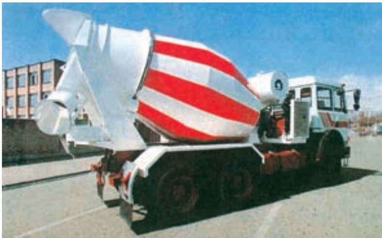
شکل ۶-۴- تراک میکسر (شامل مخزن مخلوط‌کننده، پمپ آب و قیف تخلیه)
