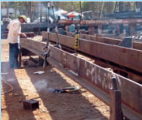
مونتاژ وجوه سوم و چهارم در روش مونتاژ تک مرحله‌ای ستون‌های صلیبی
