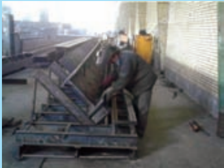
جوش طولی به روش زیرپودری
