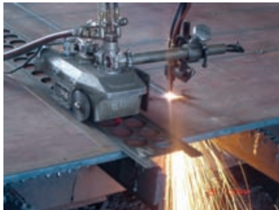
شکل ۱۱-۲- دستگاه برش ریلی
