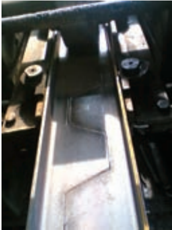
الف- برش غلتکی تیرهای لانه‌زنبوری
