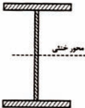
شکل ۱۱-۹- محور فنتی در تیورورق متقارن H شکل
