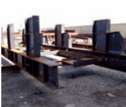
شکل ۱۱-۱۵- فیکسچر مونتاز نهایی قطعات الماقی دستک‌ها روی ستون صلیبی شکل
