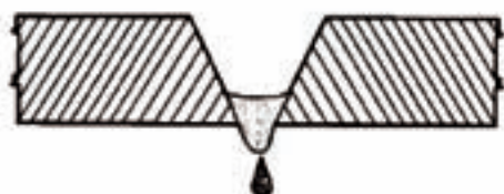
ب- ریزش مذاب در ریشه‌ی جوش درز فوق
