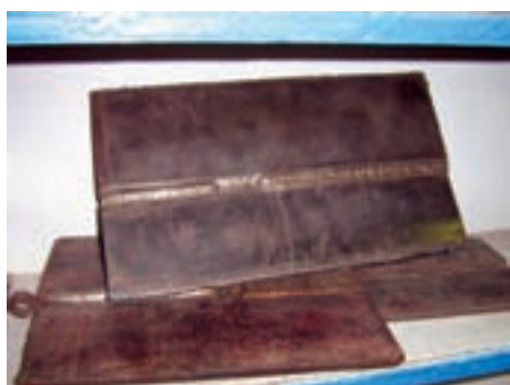
شکل ۱۲-۱۱- نمونه درز جوش شده شیاری
