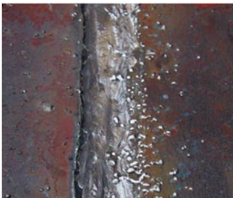
شکل ۱۲-۲۱- نمونه‌ای از پاشش جوش
