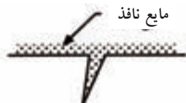
الف- مایع نافذ رنگی یا فلورسنت در داخل ناپیوستگی تراوش می‌کند
