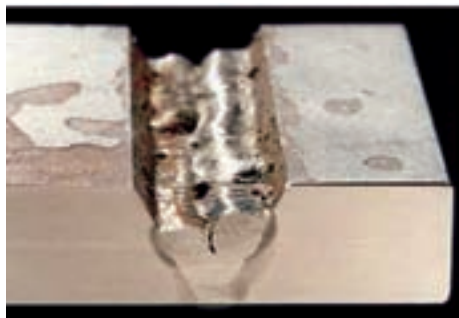
شکل ۱۲-۱۰- ذوب ناقص در پاس (ویی جوش
