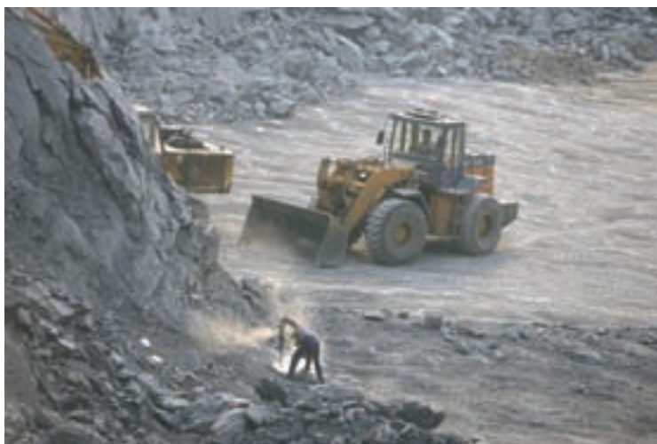
شکل ۹-۱- استخراج سنگ معدن جهت مصرف در کارخانه سیمان
