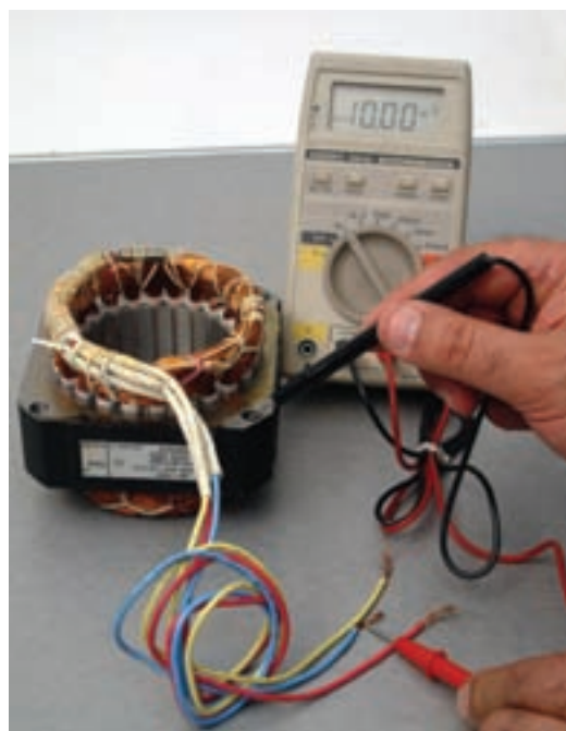
شکل ۸-۱۰- تست اتصال بدنه
