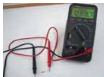
شکل ۱-۲۱ نحوه اندازه گیری مقاومت با اهم متر.
