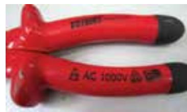
(الف) دسته عایق انبردست (در برابر ۱۰۰۰ ولت)
