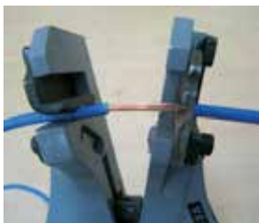
شکل ۳-۸ مراحل لخت کردن سیم توسط سیم لخت کن اتوماتیک.
