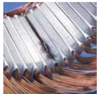
شکل ۲-۲ اتصال سیم‌های حامل جریان با بدنه فلزی یک موتور الکتریکی.
