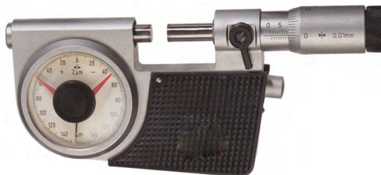
شکل ۲۹-۵- میکرومتر عقربه‌دار با صفحه دایره‌ای شاخک
