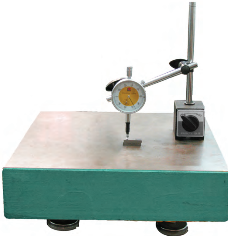
شکل ۲۱-۶- آماده‌سازی ساعت برای عملیات کنترل
