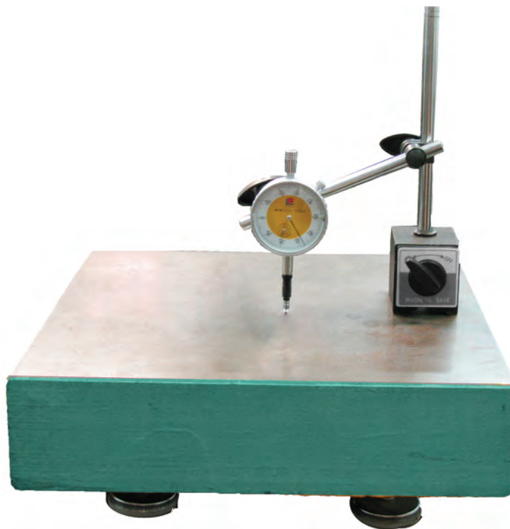
شکل ۲۰-۶- آماده‌سازی ساعت برای عملیات اندازه‌گیری
