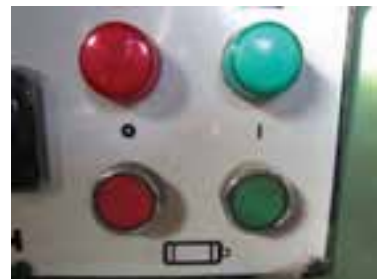
شکل ۵-۶۵ کاربرد لامپ‌های سیگنال در یک نمونه دستگاه تراش
