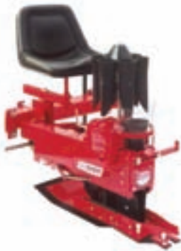
شکل ۱۱-۴- ماشین کاشت نونهال یا قلمه نیمه مکانیزه دارای لوله سقوط
