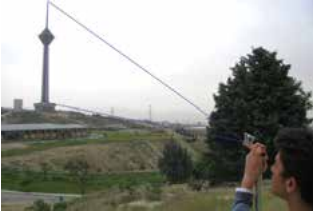
شکل ۶ - ۱۰ . کاربرد شیب‌سنج در اندازه‌گیری زاویه‌ی شیب
