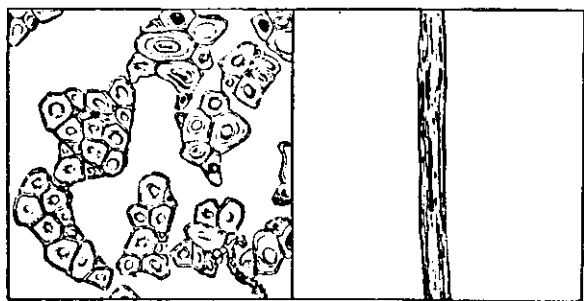
شکل ۱۴-۲- نمای طولی و مقطع عرضی الیاف چتایی
