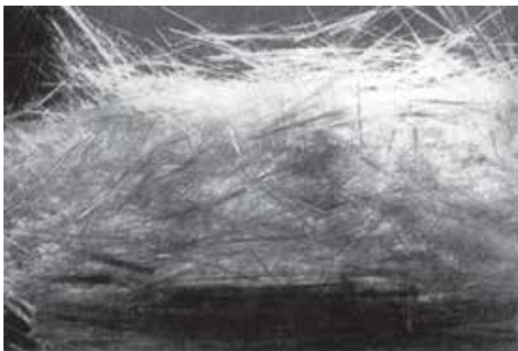
شکل ۱-۴- الیاف پنبه‌ی نسوز
