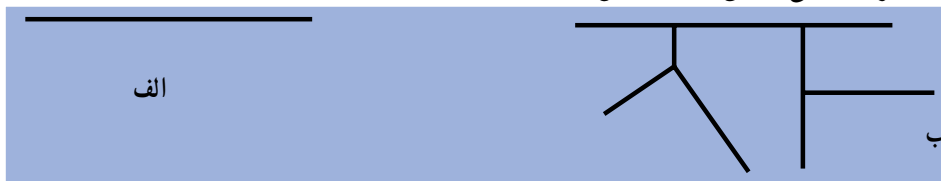
شکل ۱-۵- الف - پلیمر مناسب برای لیف شونده‌گی ب - پلیمر نامناسب برای لیف شونده‌گی
