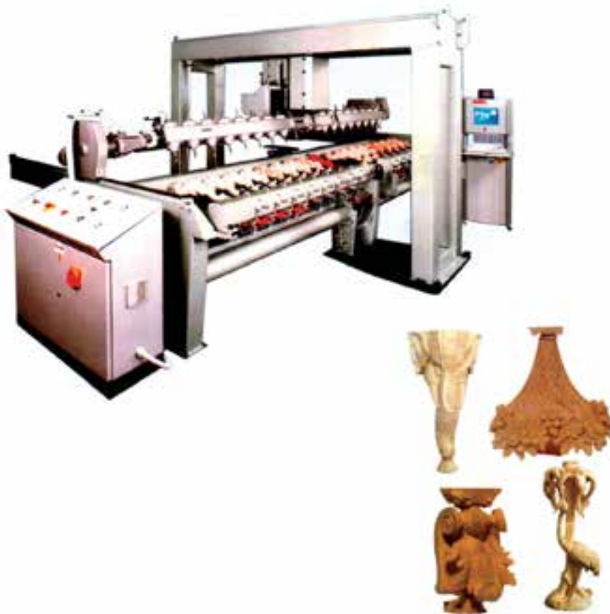
شکل ۱۰-۵ - قطعات مثبت شده با دستگاه اتوماتیک
