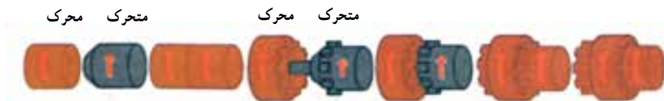
۳— هنگام هم سرعت شدن و درگیری ۲— سنکرو نیزور مخروطی و کشویی ۱— سنکرو نیزور ساده مخروطی
